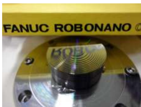
φ20 フレネルレンズ金型 (旋削加工)
