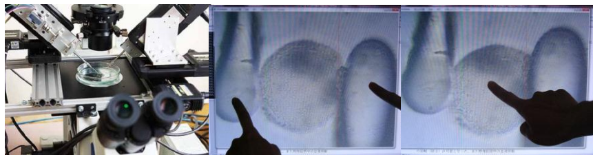
【柔軟シートを用いたハプティックデバイス】
